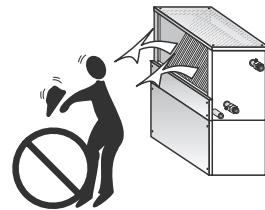
**Нельзя тянуть, наступать, пережимать, закреплять кабель гвоздями или кнопками. Поврежденный кабель может вызвать короткое замыкание или причинить травму.**
