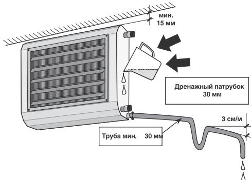
Дренажная система должна иметь сифон соответствующего размера, для того чтобы:
