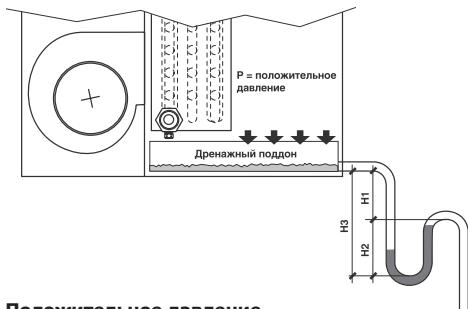
**Положительное давление****H1 (мм) = 20 мин.****H2 (мм) = P + 30 мин.****H3 (мм) = H1 + H2 = P + 50 мин.,**
