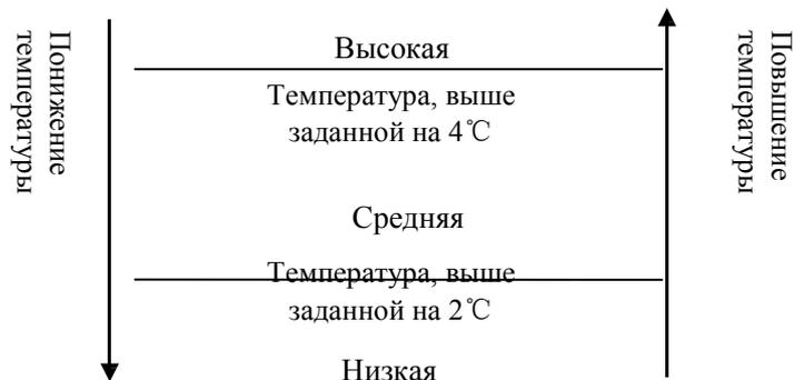
Если разница между заданной температурой и комнатной температурой равна 2°C или 4°C, то вентилятор внутреннего блока будет работать с текущей скоростью.
